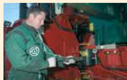
▼ Tebbe sprederne er udstyret med fire vejeceller. En af dem kan ses oven over det automatiske smørelæg, som her er ved at blive fyldt op.
